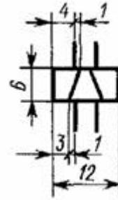
4. Катушка электромеханического устройства с одним отводом
