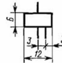
5. Катушка электромеханического устройства: с одним дополнительным графическим полем
