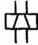
6. Катушка электромеханического устройства с двумя встречными одинаковыми обмотками (бифилярная обмотка)
