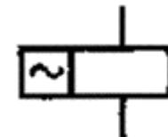
10. Катушка электромеханического устройства с указанием вида обмотки: обмотка тока
