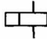
с двумя дополнительными графическими полями
