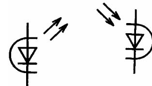
2. Взаимная ориентация обозначений источника и приемника не устанавливается, а определяется удобством вычерчивания схемы, например:
