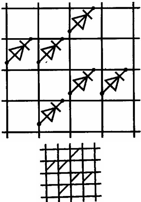
Примечание. Если все диоды в узлах матрицы включены идентично, то допускается применять упрощенный способ изображения. При этом на схеме должны быть приведены пояснения о способе включения диодов
